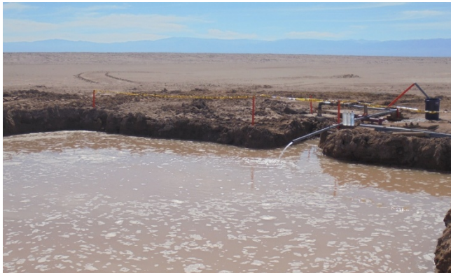
Hil-2 Agujero de perforación: prueba de flujo artesiano, marzo de 2016
